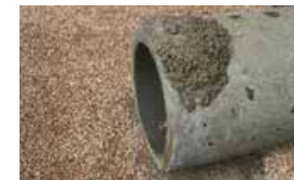
Teilweise oder komplett einbetonierte Rohre
