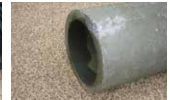
Rohre mit beschädigter Oberfläche
