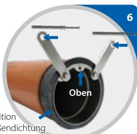
1. Ziehen Sie die Außendichtung vom Gehäuse. Demontieren Sie die Befestigungslaschen.
