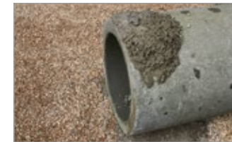
Teilweise oder komplett einbetonierte Rohre
