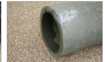
Rohre mit beschädigter Oberfläche
